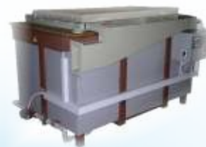
Полимеризация пропиточного состава в воде при (90 ± 5) C
